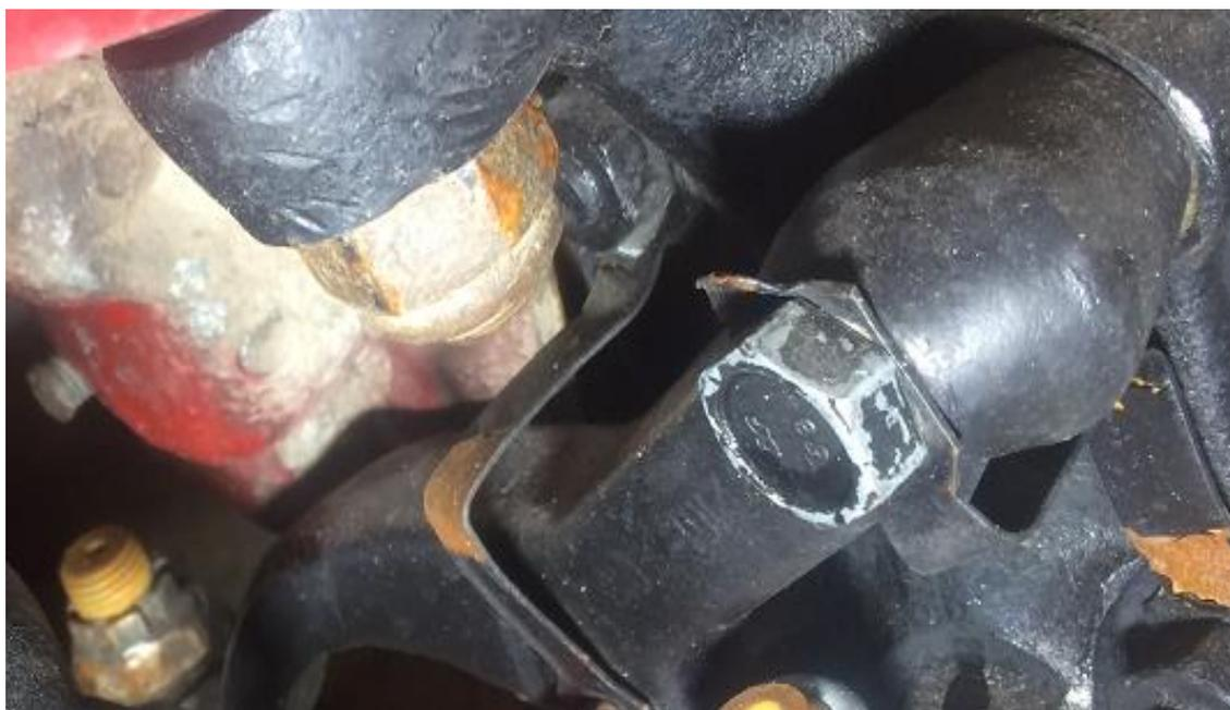
3. Устанавливаем рычаги обратно на машину, прикручивая штатным крепежом. Окончательную затяжку производить на опущенном на колеса автомобиле.
