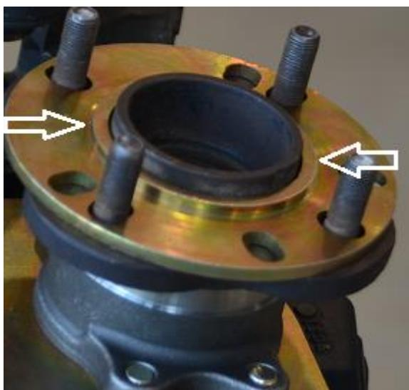
4. Устанавливаем диск , и можно ставить на Ваш автомобиль. Второй вариант считаем более надежный т.к. ступица встает на свое посадочное место, а так же центруется тормозной диск.
