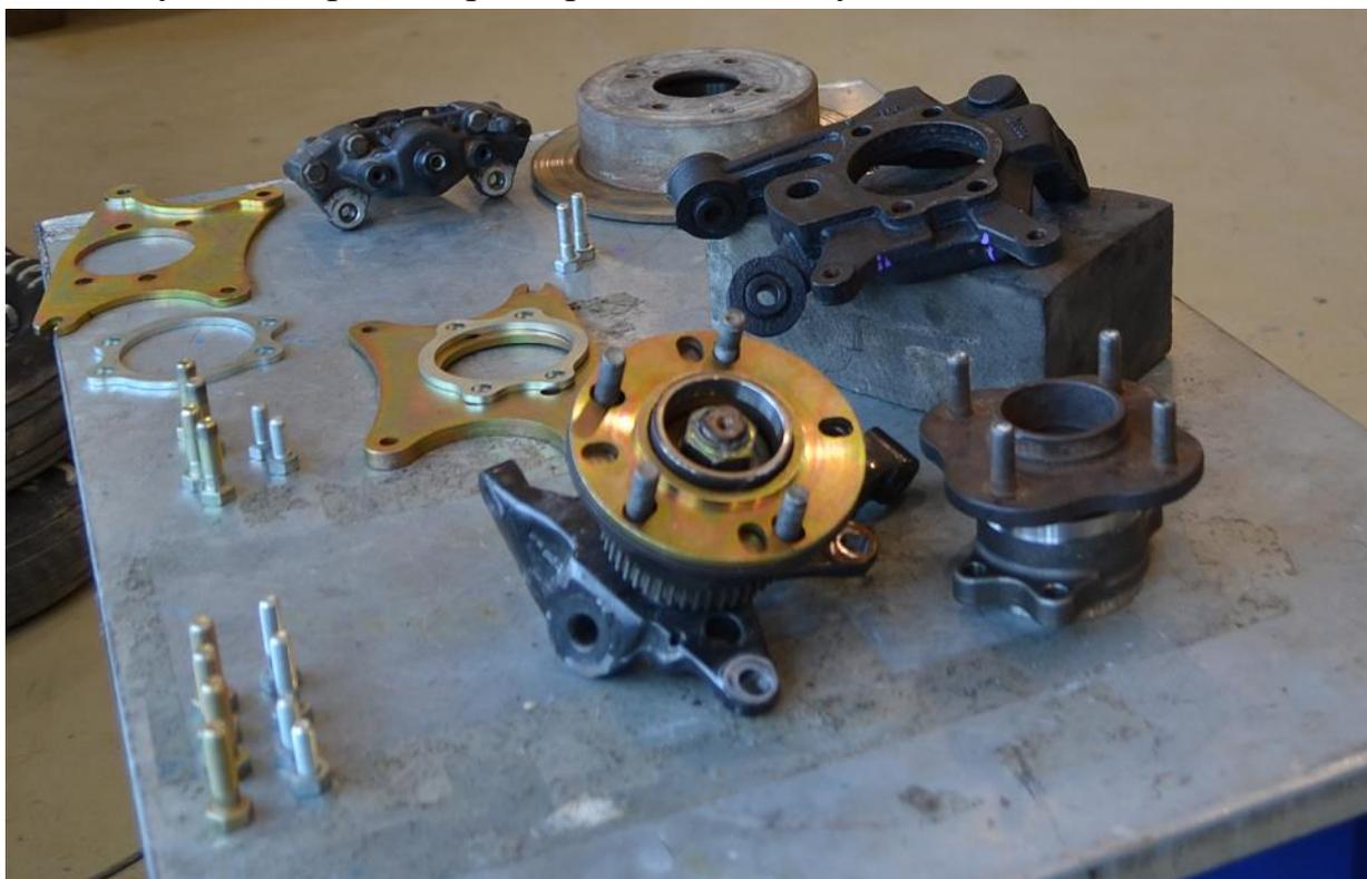
2. Первый вариант сборки осуществляем без проставки тормозного диска , а применяем проставку под ступицу . Она даст нужное смещение тормозному диску и ступице в целом для нормальной установки суппортов.
