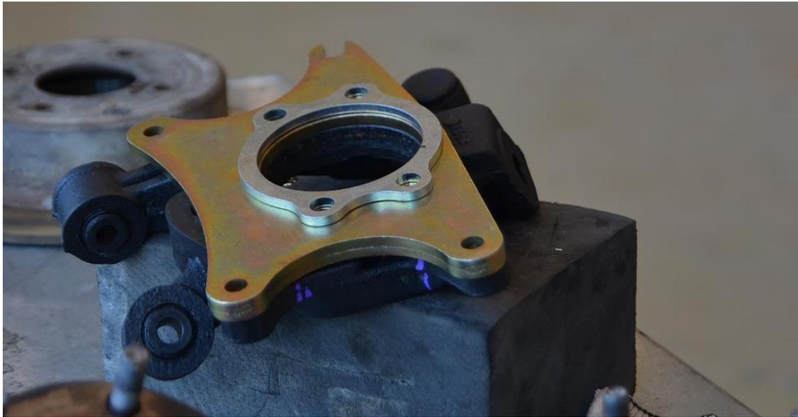
3. Прикручиваем ступицу комплектными болтами (**позиция 5**), т.к. штатные болты будут короткие. Для удобства, сначала прикручиваем суппорт на дополнительное место крепления, комплектным крепежом (**позиция 6,8**).
