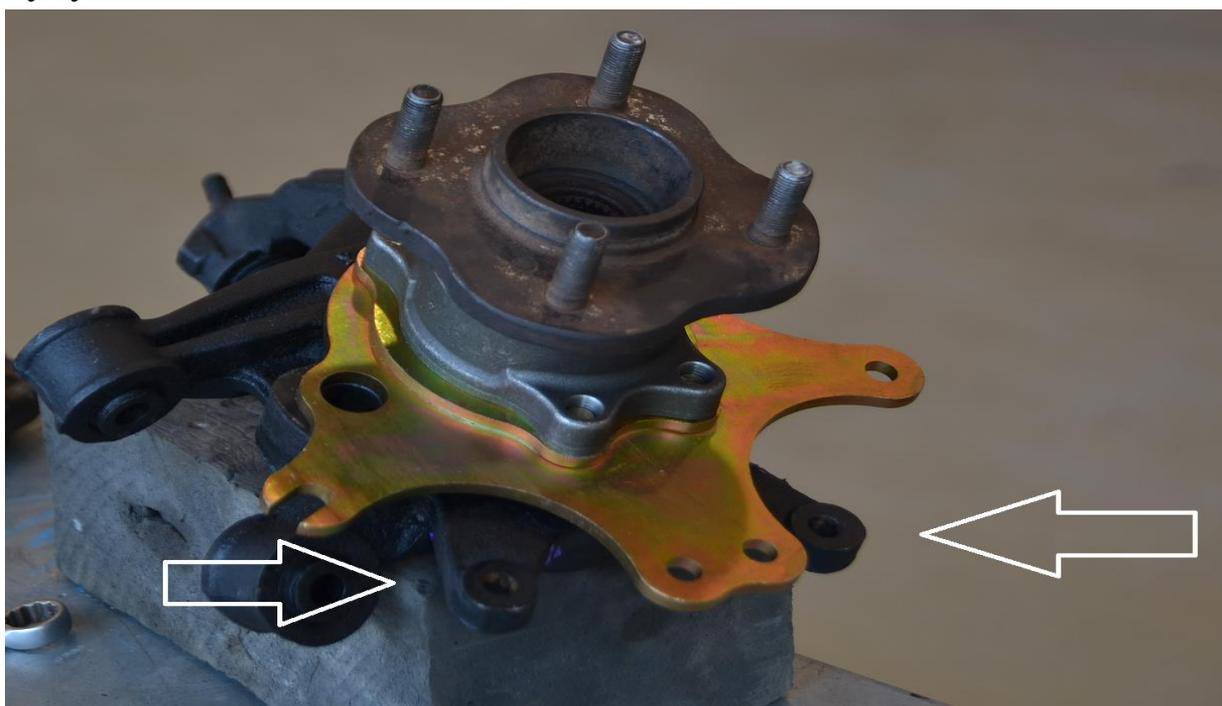
2. Отмечаем как нам нужно отрезать крепления штатного суппорта и вырезаем.
