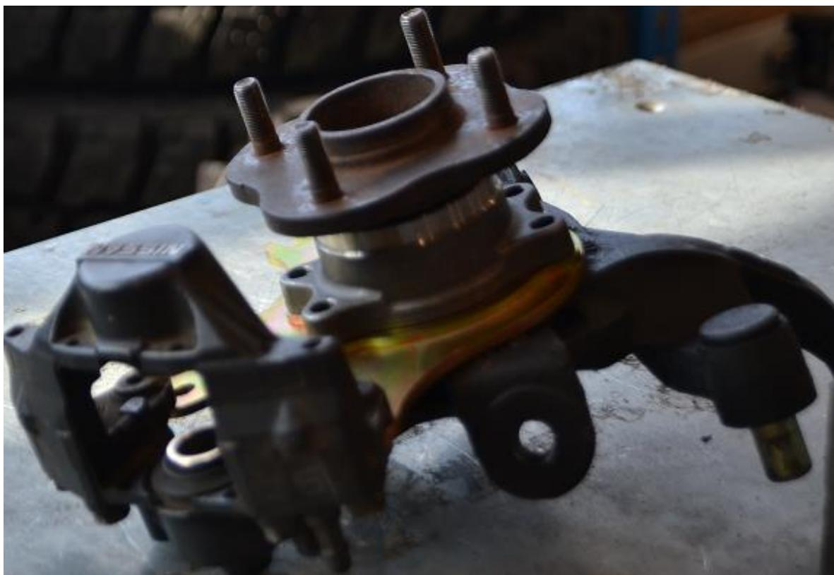
4. Так же, если у Вас остается штатный нижний рычаг, то его придется зашлифовать под суппорт. Некоторые тюнингованные рычаги подходят без доработки. Делается это для избегания контакта рычага и направляющей суппорта при работе подвески и нормальной возможности установить все вместе.
